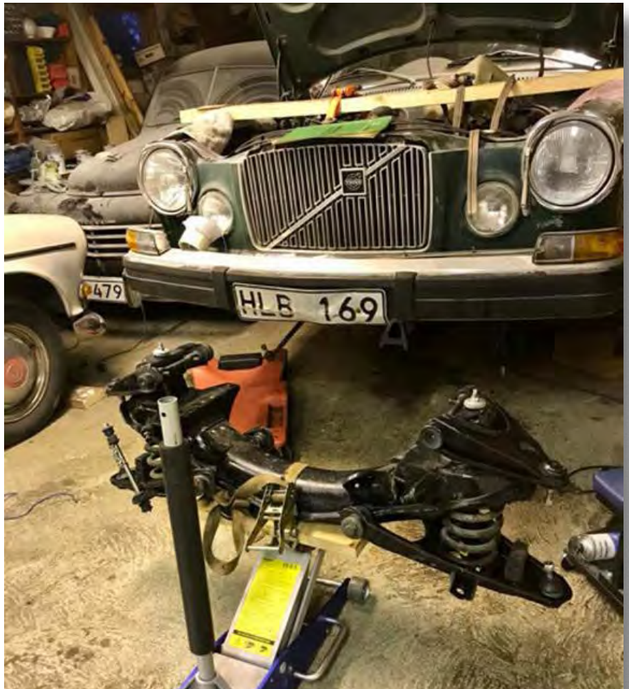
Nya framaxelbalken redo att monteras. Motorn stöttades upp med en kraftig bräda och spännband till främre motorfästena medan framaxeln renoverades.
